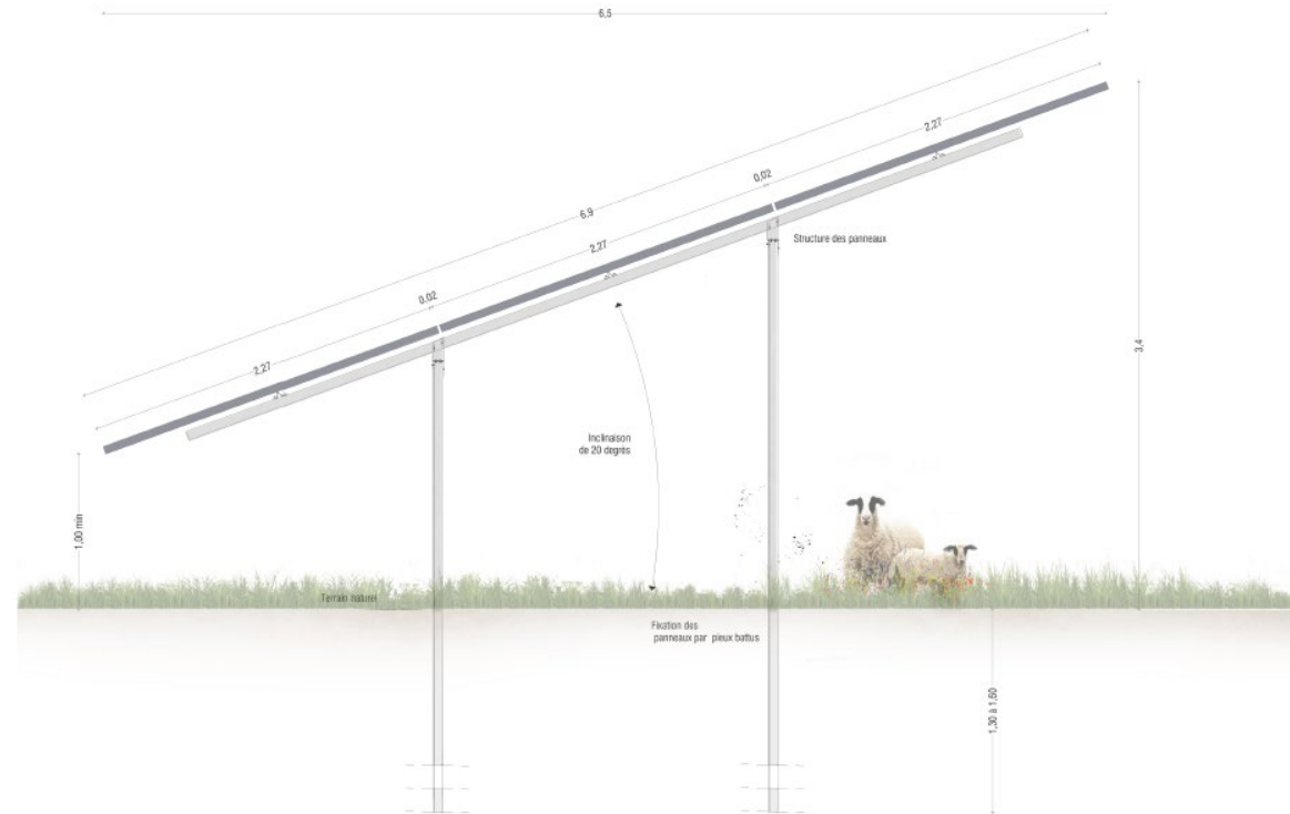
VUE EN COUPE D'UNE TABLE PHOTOVOLTAÏQUE
